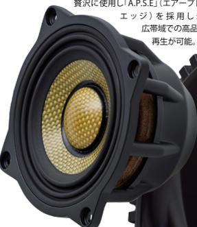
●アルミダイキャスト製バッフルソニックデザイン最高級シリーズ「プレミアムライン」と同等の超精密製造。「Gチューナー」をバッフル側面部に一体化し高剛性化。さらにドライバーをバッフル部に固着させることで振動板の微細な動作もあまらずことなく音波に変換。バッフル面の3次元フラア形状により色付けのない自然なスムーズなサウンドで音楽を再生します。
