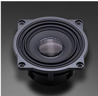
独自のマイクロスピーカー・テクノロジーにより、小口径ならではの音の切れ味と、小口径の限界を打ち破るワイドレンジ再生とを両立した77mmウーファーユニット＝「S-77E」型を採用。新世代のDMF(ディファインド・マイクロファイバー)振動板と駆動系の動作精度を向上させてボイスコイルギャップを狭めたナローギャップ・モーターシステム、A.P.S.E.(エアプレッシャー・スムージングエッジ)を投入し、クラスを超えた正確で情報量豊かな再生音を実現しています。
