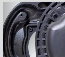
166mm)のアルミハイブリッドエンクロージャは、上級の「プレミアムライン」シリーズと同等の超精密鑄造アルミダイキャストをバッフル部に、適度な内部損失を備えた特殊樹脂をバックチャンバー(裏ケース)部に採用。振動モードの違う異種素材を強固に結合する2ピース構造で不要共振を最小限に抑え、色づけない再生音を実現しました。一般的な純正16(17)cmスピーカーに適したモジュール「J」(取り付け奥行37mm)、純正16cmスピーカーで小さな取付開口径に適したモジュール「K」(取付開口径115mm)と同じく奥行の異なるモジュール「L」(取り付け奥行40mm)、純正13~16cmスピーカーで狭小部においても装着が可能なモジュール「H」(バッフル面奥行18mm)の4種類を用意し、取付条件に応じてお選びいただけます。
