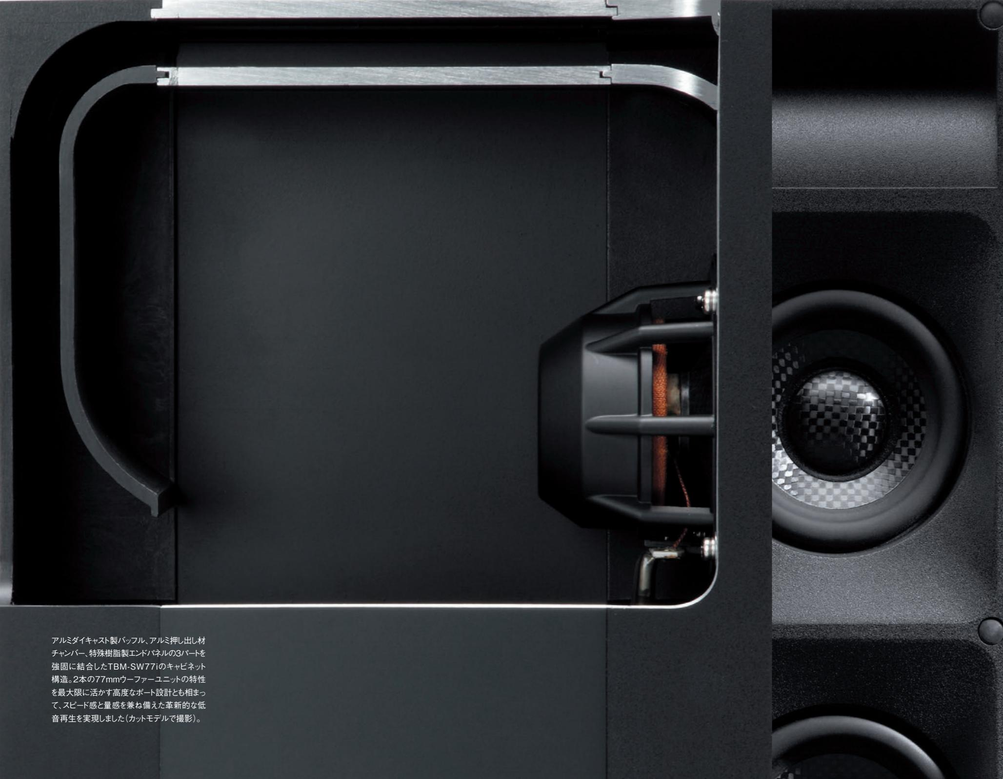
アルミダイキャスト製バッフル、アルミ押し出し材チャンバー、特殊樹脂製エンドパネルの3パートを強固に結合したTBM-SW77iのキャビネット構造。2本の77mmウーファーユニットの特性を最大限に活かす高度なポート設計とも相まって、スピード感と量感を兼ね備えた革新的な低音再生を実現しました(カットモデルで撮影)。
