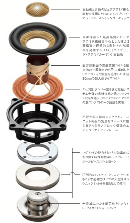
77mmウーファーユニット(SD-N77N型*)の内部構造
