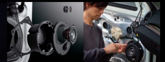
左:フルエンクロージャ方式の音が手軽に楽しめるよう考案されたカジュアルライン カースピーカーの内部構造 右:お客様のご要望に添った究極的なカスタムインストールを提供する認定販売店でのスピーカー取り付け風景
